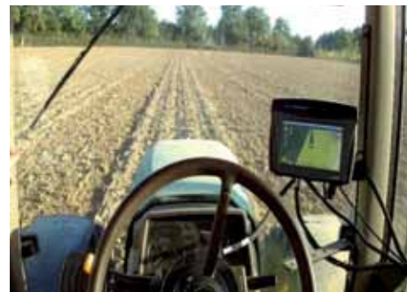
Console de guidage avec volant électrique.
