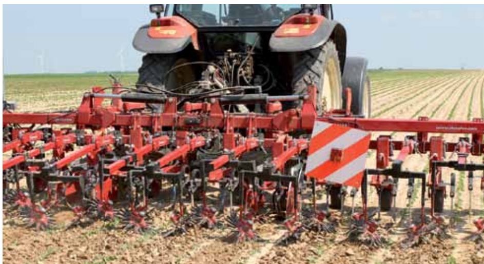
Démonstration de binage avec une bineuse STEKETEE 12 rangs à moulinets équipée de caméras sur une parcelle ayant souffert de la battance.
